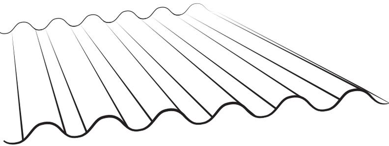
PERFIL ACANALADO DE PERFIL TRAPEZOIDAL U ONDULADO, FABRICADO MEDIANTE UNA ROLADORA A PARTIR DE UN ROLLO DE LÁMINA Y DISEÑADOS PARA SER UTILIZADOS COMO CUBIERTAS DE FIJACIÓN EXPUESTA.
